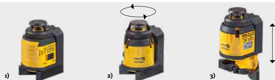
1) Parkstellung. 2) Gehäuse im U-Griff um 360° schwenkbar. 3) Durch den ausziehbaren Fuß ist der Laser höhenverstellbar. Die Anlagefläche ermöglicht das Positionieren des Lasers z. B. an U-Profilen.
