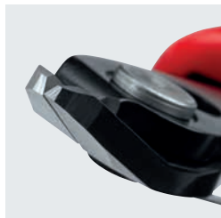
Schaarsnede met gecontroleerde microsnijkantverstelling voor langere levensduur en ultraprecisie ook bij het knippen van de dunste draden.
