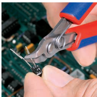
De schuinere snijkanten van de Electronic Super Knips 78 23 125 snijden gemakkelijk verticaal geplaatste draden, zelfs van bovenaf.
