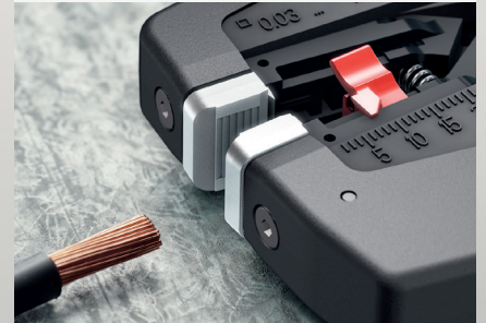
Automatisch strippen tot 10 mm 2 .
