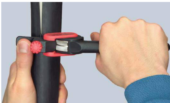
Eromheen draaien van het gereedschap voor een omtreksnede
