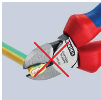
Een kabel knippen met een zijsnijtang: veel kracht nodig, onzuivere snede en ingrijpende vervorming van de kabel
