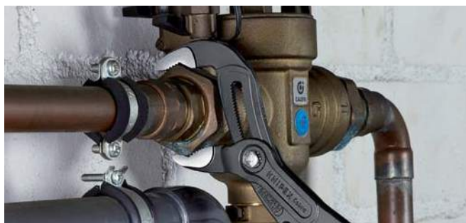
Tegen de draairichting in verzette tanden zorgen voor een zelfklemmend effect en verhinderen wegglijden aan het werkstuk
