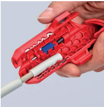
Ontmantelen van een NYM-kabel
