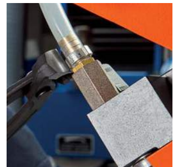
Afdichtingen van slangaansluiting aan centrale smering
