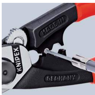
De eindhulzen op de trekkabel persen
