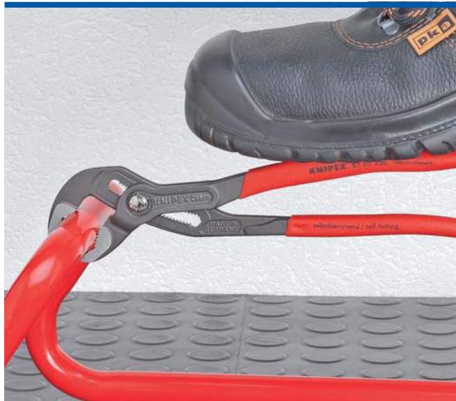
Tegen de draairichting in verzette tanden zorgen voor een zelfklemmend effect en verhinderen wegglijden aan het werkstuk
