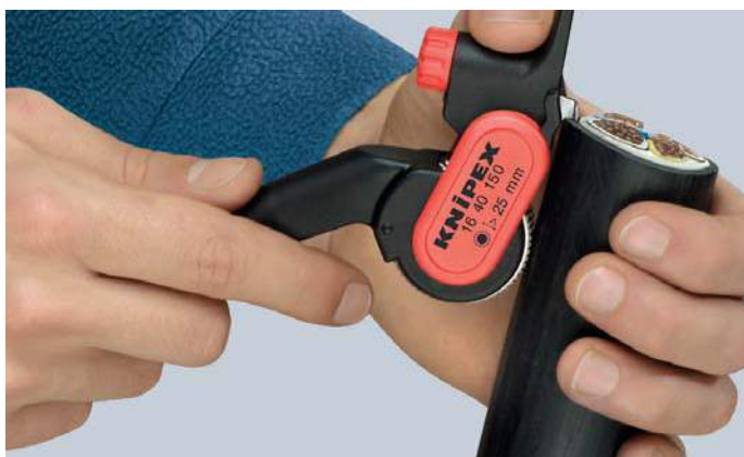
Klaarzetten van het gereedschap voor een lengtesnede
