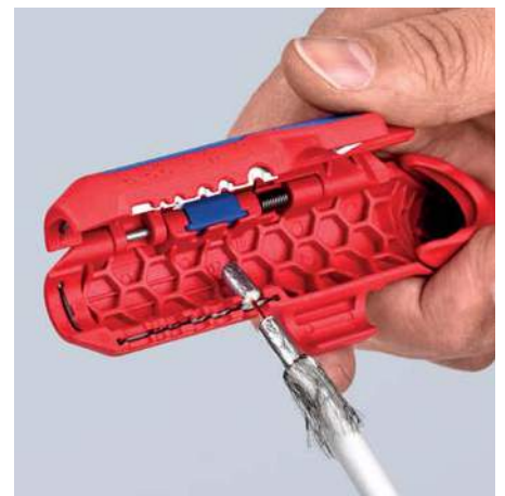
Afstripten van een coax-kabel
