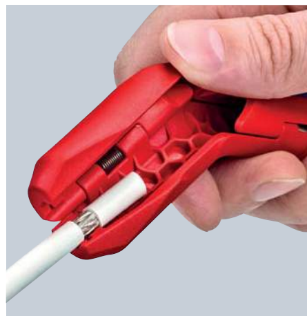
Afstripten van een coax-kabel
