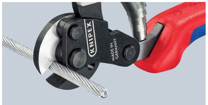
Knippen van zeer stevige staaldraadkabels (1960 N/mm 2 ) tot Ø 4 mm
