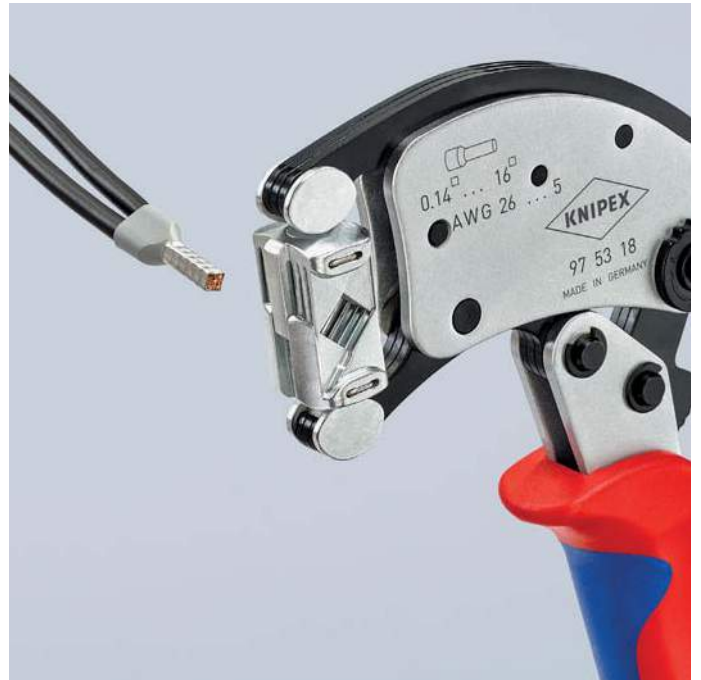
Twin-adereindhulzen tot 2 x 6 mm 2 kunnen zonder verstelling geperst worden
