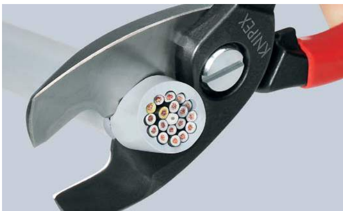
Definitieve snede: nadat de mantel van de kabel in het voorste profiel doorsneden wordt, wordt de kabel in het achterste profiel doorsneden. Vorbereidende snede vooraan, doorknippen achteraan. Zo knipt men makkelijker.
