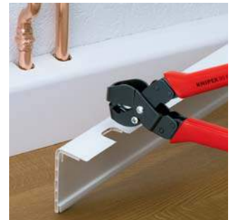
Speciale tangen voor bijzondere toepassingen, bijvoorbeeld om uiteenlopende materialen uit te klinken of uit te stansen (knabbel-schaar voor plaat, tegelknijptang enz.)
