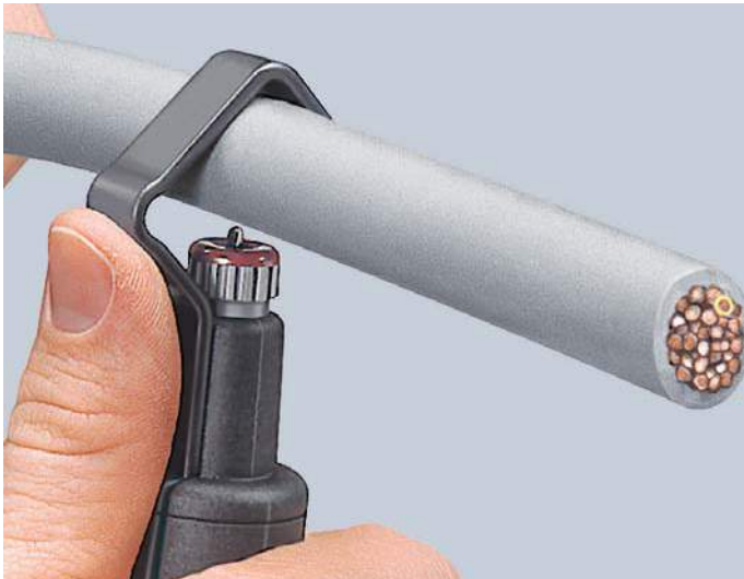
Positionering van het gereedschap voor het ontmantelen
