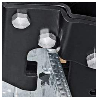
Het ponsgereedschap wordt door de plaat gedrukt
