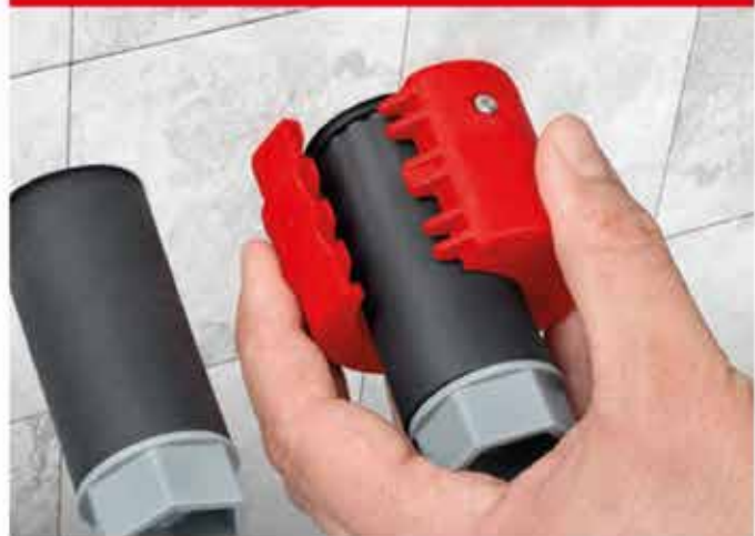
Door de unieke constructie van het roterende messenblok kunnen druppel- en afdichtingsmanchetten betrouwbaar 2 tot 3 mm voor de muur worden ingekort om vocht veilig af te voeren.
